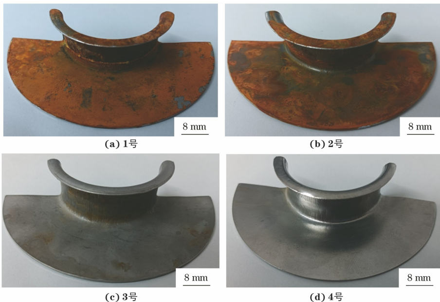
图 3 几种试样经过 96 h 盐雾试验后的表面形貌
