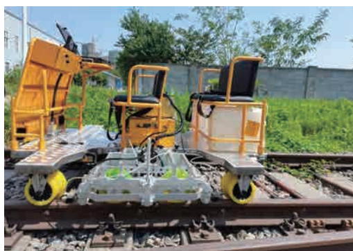
图5 采用串列式轮式探头的双轨式钢轨超声检测仪 外观
