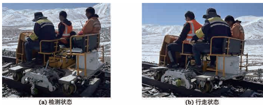
图9 轨底焊缝轮式探头检测现场
