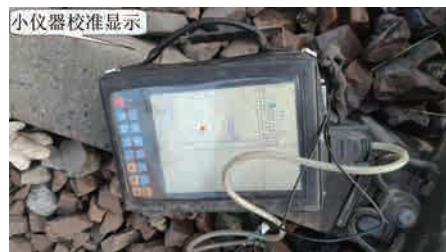
图15 轮式探头串列式扫查发现的铝热焊伤损的复核A扫描波形
