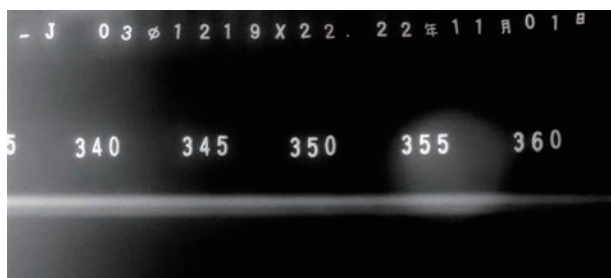
图 19 铅字 / 磁铁 / 像质计的铅字投影到焊缝区域的 DR 检测图像
