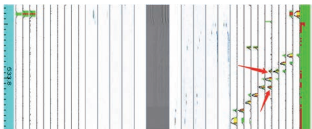
图5 相同坡口角度的相邻反射体波幅不符合标准要求的AUT检测图谱
