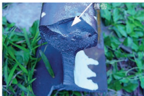
图 1 PD3 热轧钢轨斜裂纹内部核伤
