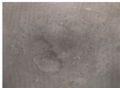
图1 EA4T 钢坯中的斑点状偏析
