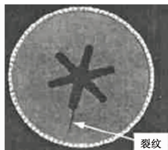
图 4 ICT2500 重建的火箭发动机 CT 切片
