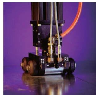
图2 激光拼焊板电磁超声检测探头装置
